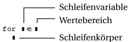
Mengenschleife, bei der die Schleifenvariable nacheinander alle Werte des Wertebereichs annimmt. Der Wertebereich ist meist ein Vektor von Zahlen, der mit der Funktion `range` erzeugt wird.
